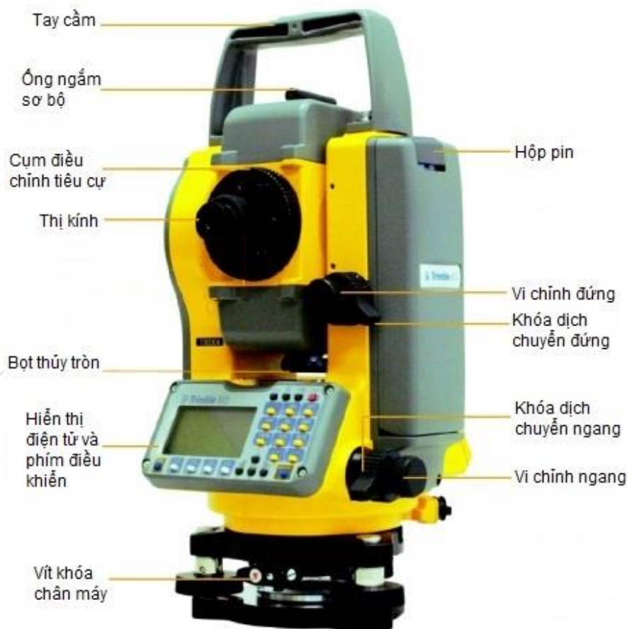
Hình 1. Cấu tạo của toàn đạc điện tử
