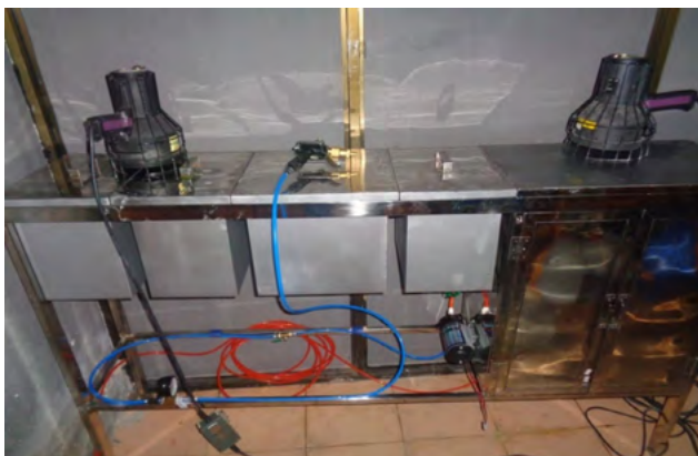
Hình 2: Hệ thiết bị kiểm tra thấm lỏng bằng kỹ thuật bồn bể
