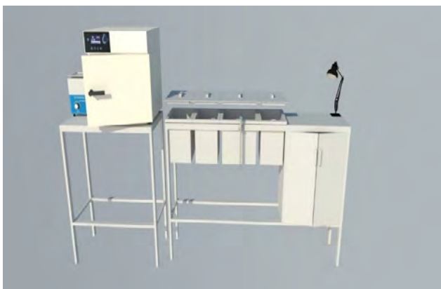
Hình 1. Bản vẽ 3D Hệ thiết bị kiểm tra - Thấm lỏng bằng kỹ thuật bồn bể.
