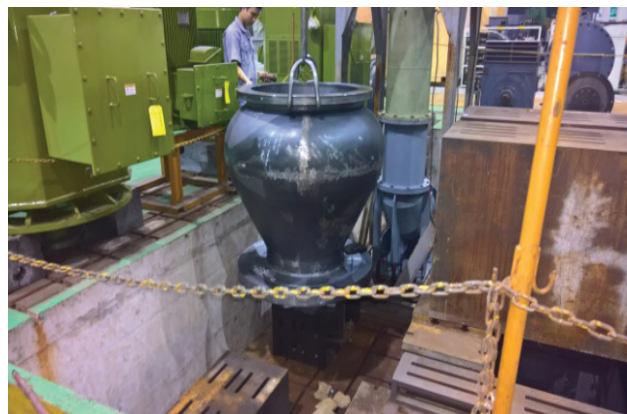
Hình 7. Kiểm tra chất lượng ống áp của bơm bằng phương chụp ảnh phóng xạ
