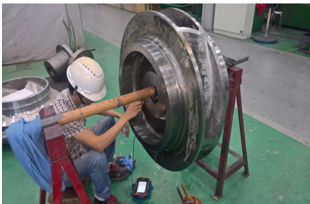
Hình 4. Kiểm tra chất lượng cánh bơm bằng phương pháp siêu âm
