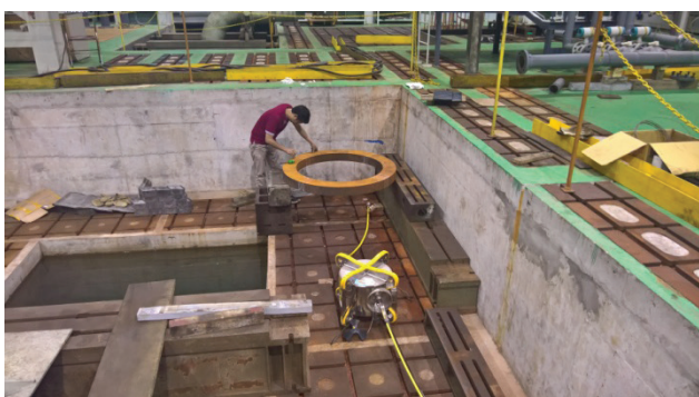
Hình 4. Kiểm tra chất lượng cánh bơm bằng phương pháp siêu âm
