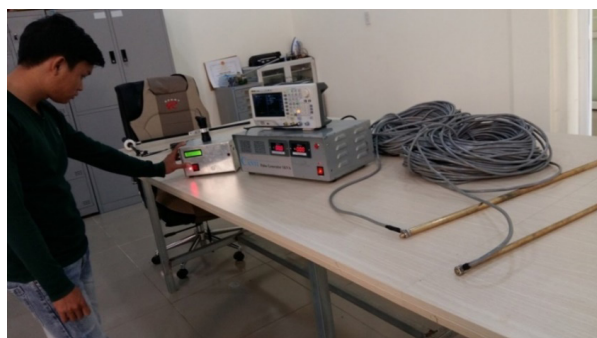
Hình 5 : Máy phát dòng và điện cực do CANTI chế tạo
