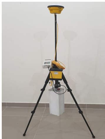
Hình 4 : Hệ thiết bị đo từ trường cảm ứng do CANTI chế tạo
