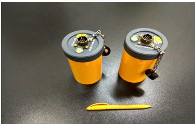
Hình 17: Hình dáng bên ngoài của cảm biến đo từ trường cảm ứng
