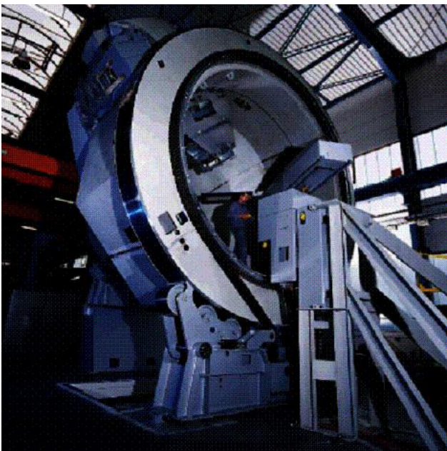
Hình 5. Hệ thống lựa chọn và lái chùm proton của các máy gia tốc xạ trị proton truyền thống
