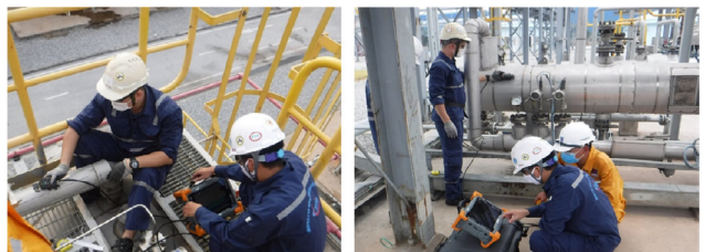
Kiểm tra PEC trên hệ thống ống và các vị trí valve,...
