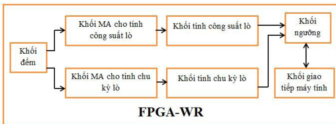
Hình 1. Sơ đồ khối của khối đo và kiểm soát thông lượng neutron FPGA-WR
