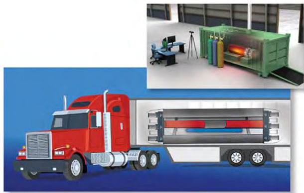
Hình 2. Các lò phản ứng siêu nhỏ và có thể vận chuyển được [4, 5], có thể cung cấp năng lượng cho các cộng đồng ở vùng sâu vùng xa, hỗ trợ các lưới điện siêu nhỏ độc lập và khôi phục điện cho các khu vực bị thiên tai với khả năng được vận chuyển, lắp đặt và khởi động trong vài ngày
