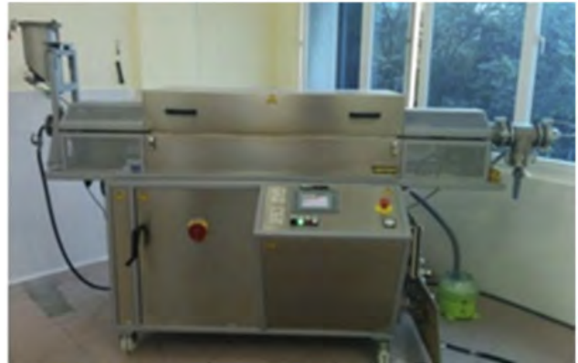
Hình 3. Lò nung quay điều chế bột UO_2 ex-AUC
