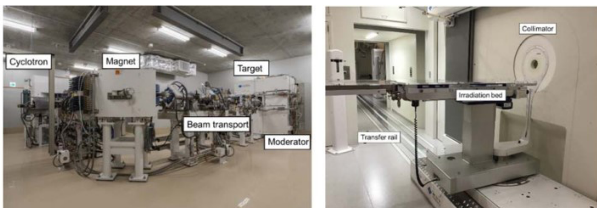
Hình 2: Một số thành phần của thiết bị xạ trị BNCT (máy gia tốc, buồng chiếu xạ bệnh nhân)
