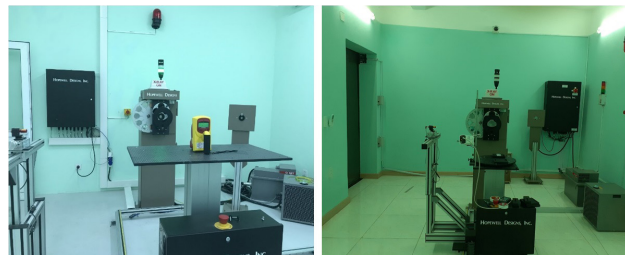
Hình 1. Trường chuẩn liều bức xạ tia X: (trái) tại Viện Khoa học và Kỹ thuật Hạt nhân; (phải) tại Trung tâm Hạt nhân thành phố Hồ Chí Minh
