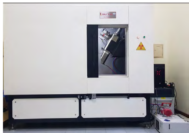
Hình 5. Hệ thống CBCT hoàn chỉnh được chế tạo tại Việt Nam
