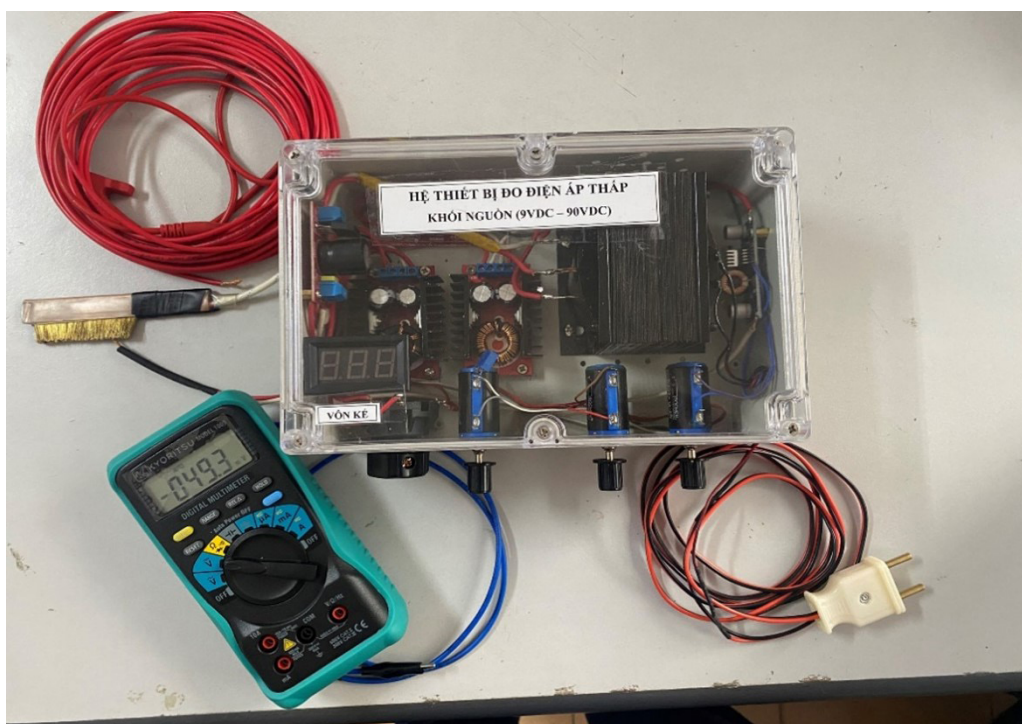
Hình 3. Bộ nguồn cung cấp dòng điện DC và đầu đo kiểm tra điện áp thấp
