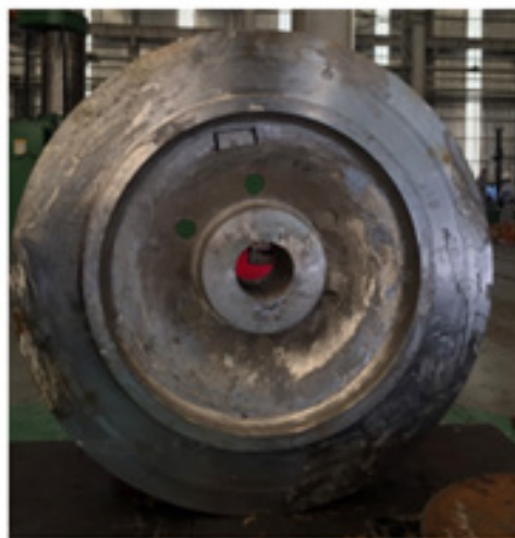
Hình 1. Cánh bơm nhìn từ mặt trước (trái) và mặt sau (phải)
